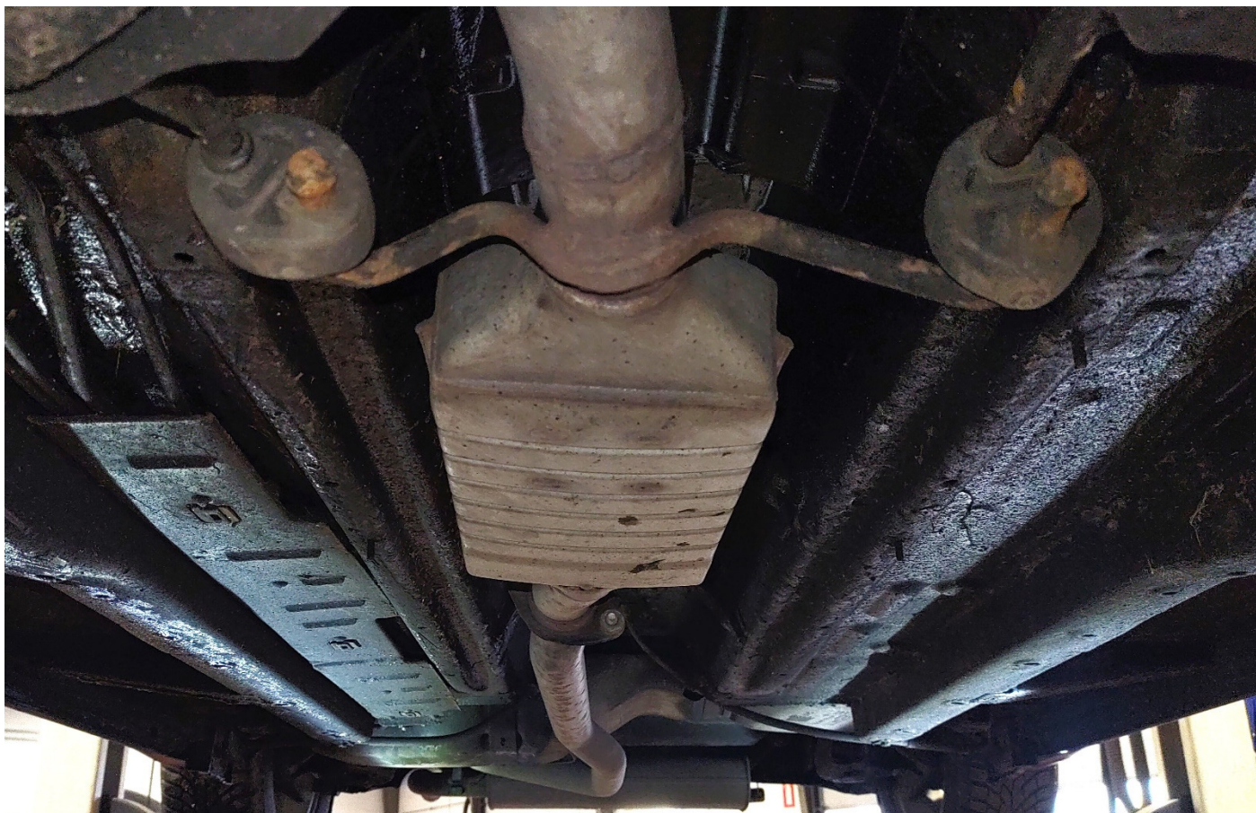
DPF enhed svejset på original udstødning, skåret foran bøjle til ophæng. Bøjle flyttes over på indgangsrør DPF
