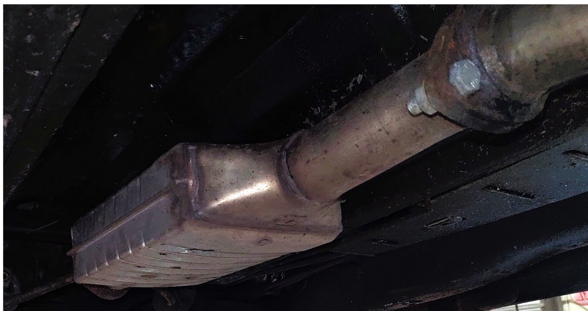
Afgangsrør fra DPF svejses på før flangesamling. Studse på filter sidder skrå, så filteret forskydes mod midten.
