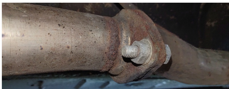
Afgangsrør fra DPF svejses på før flangesamling. Studse på filter sidder skrå, så filteret forskydes mod midten.
